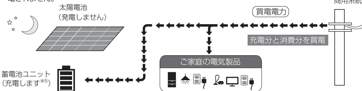
※ 1. 不足していない場合でも、商用系統に逆流しないように約 0.1kW を買電します。
