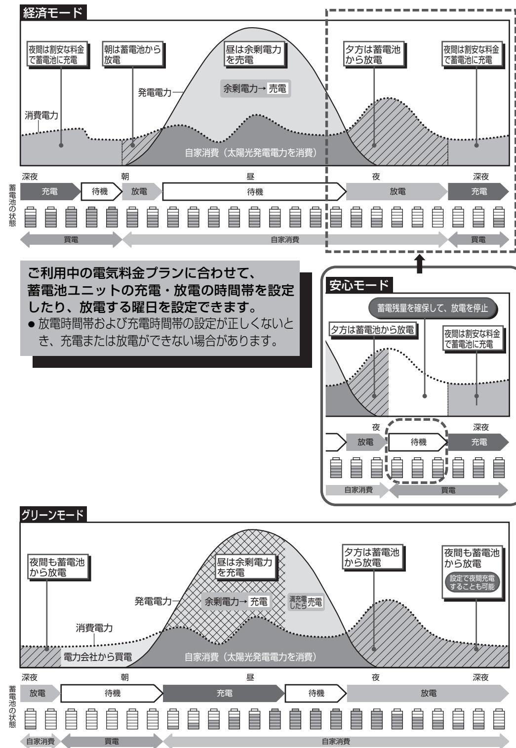
経済モードでは、昼間に余剰電力を売電して、夜間に割安な電気料金で充電し、朝夕には蓄電池ユニットから放電し、電気代を節約します。
