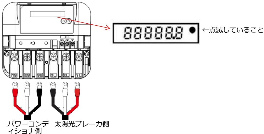
もし、上図のように表示部の右上の●が点滅（点滅間隔は発電量に依存）していなければ誤配線（逆接続）です。正しい値を取得することができないため、配線を確認してください。
