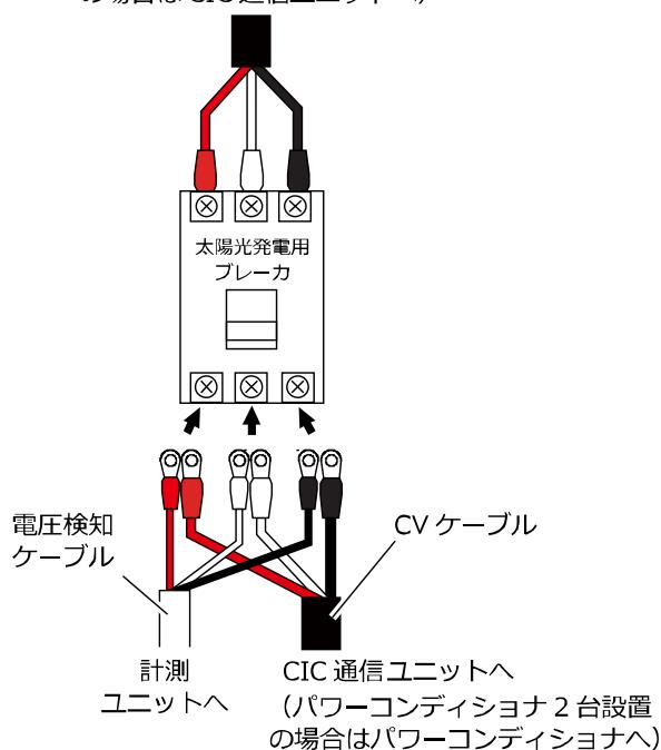
締め付けトルクは太陽光発電用ブレーカの仕様に合わせてください。
