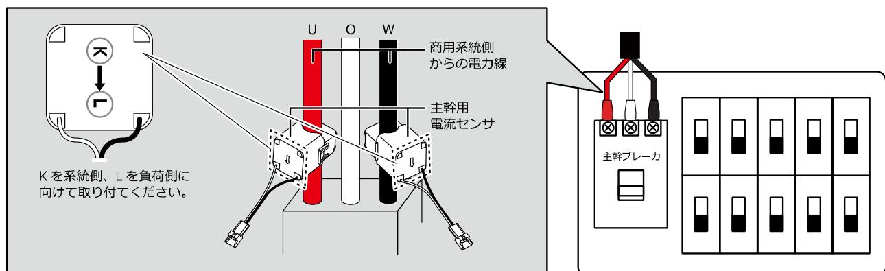
※太陽光発電用ブレーカの一次側を主分電盤の一次側に接続する場合、主幹用電流センサを太陽光発電用ブレーカからの配線に取り付けないよう注意してください。
